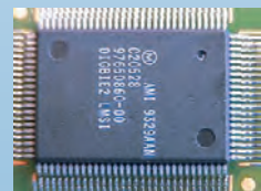
6. Fertig - mit gleichmäßig ausgeformten Lötstellen
