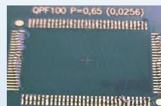
1. Pad mit Flussmittel benetzen
