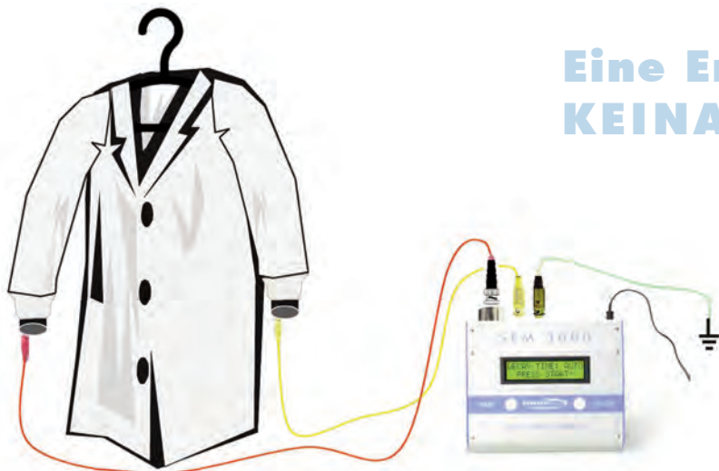
Anordnung zur Messung des Ladungsabbauverhaltens (DECAY) von EPA-tauglicher Arbeitskleidung
