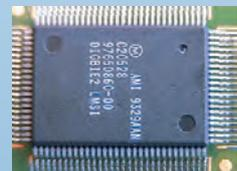
6. Fertig - mit gleichmäßig ausgeformten Lötstellen
