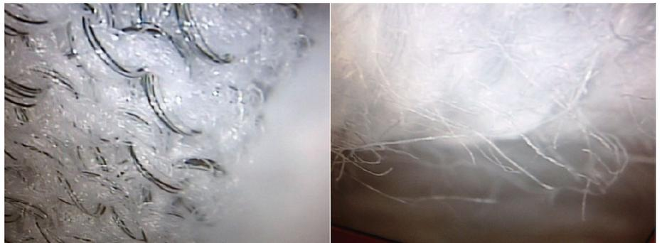
Durch Lichtreflektionen der Mikroskopbeleuchtung ist eine optische Unterscheidung zwischen Leitfasern und Fasern des Grundmaterials gelegentlich schwierig. Deshalb ist es sinnvoll, Kontaktversuche unter dem Mikroskop durchzuführen, um die Gewissheit zu haben, dass es sich bei den Fasern um leitfähige Komponenten handelt.
