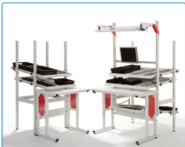
Die Regalsysteme sind für das FIFO-Prinzip konzipiert - was zuerst zugeführt wird, wird auch zuerst entnommen. Über geeignete Ablagen, optional ergänzt mit Trennstegen und Röllchenleisten, bewegen sich Behälter selbstständig von der Zuführung zur Entnahmeposition.
