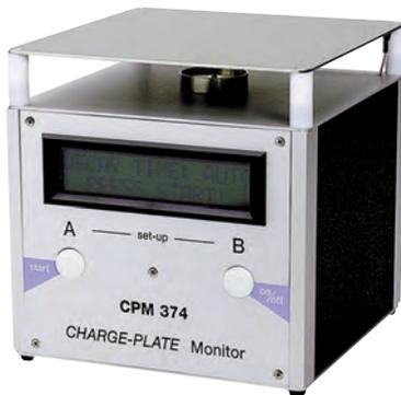
Der CPM 374 eignet sich durch seine kompakte Bauweise und durch den Akku-Betrieb hervorragend für den mobilen Einsatz, zur Akkuschonung wird dabei auf die Hintergrundbeleuchtung des Displays verzichtet.
