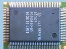
6. Fertig - mit gleichmäßig ausgeformten Lötstellen
