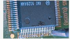
4. Bauteil an 1 Lead fixieren, Position überprüfen, danach diagonal an 2. Lead fixieren.
