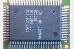
6. Fertig - mit gleichmäßig ausgeformten Lötstellen
